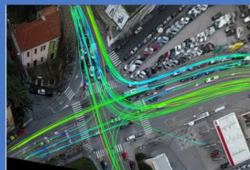
A fianco vengono illustrate le traiettorie di ogni singola fase semaforica. È stato creato un filtro che visualizza le traiettorie riguardanti specifici gate di entrata e di uscita, per ogni immagine si possono vedere le manovre possibili di ogni fase semaforica; ovviamente le manovre sono state compiute in tempi diversi all'interno dell'intervallo analizzato (30 minuti, dalle 7:45 alle 8:15).
